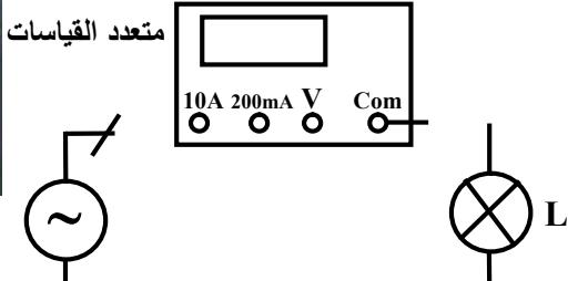
12. أكمل ربط دارة قياس شدة التيار بمتعدد القياسات
